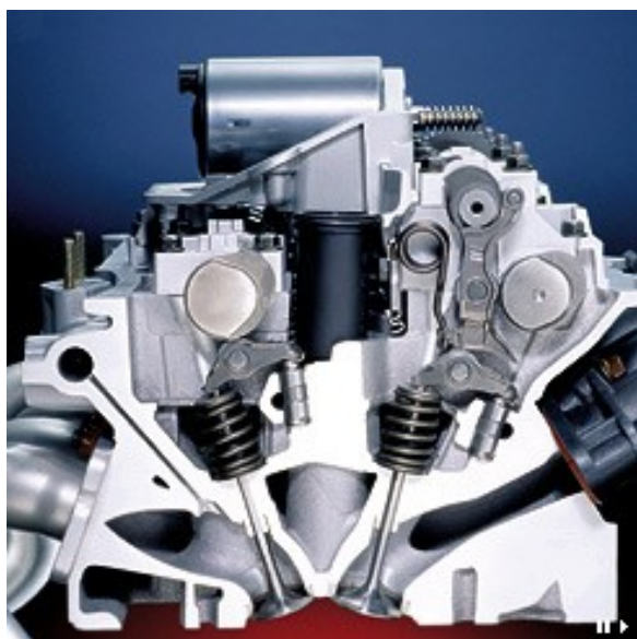
Рис. 5. Реализация системы VALVETRONIC
