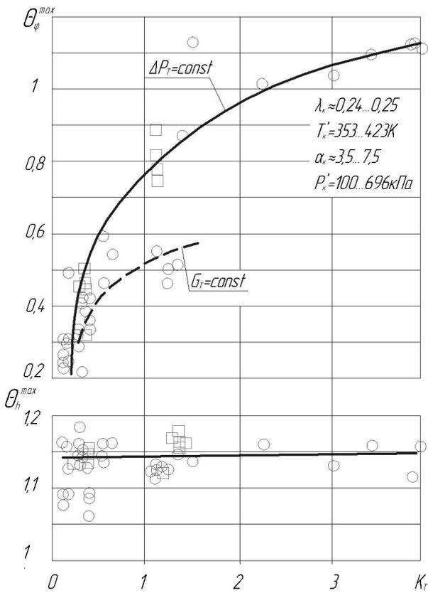
Рис. 4. Влияние начальной неравномерности распределения топлива по форсункам на характеристики выходного поля температуры газа камер МГТД
