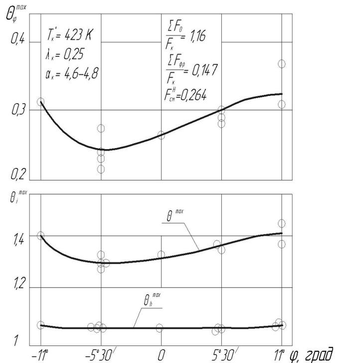
Рис. 2. Влияние остаточной закрутки на выходе из компрессора на характеристики выходного поля температуры газа камеры сгорания двигателя МД-120
