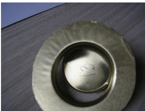
Потеря устойчивости фланца при достаточной силе прижима а)
