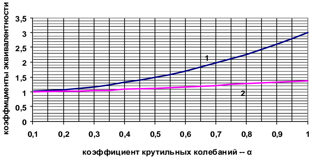
Рис.7. Коэффициенты эквивалентности для роликового подшипника качения 1- по числу циклов- KEN; 2- по усилиям- KEF
