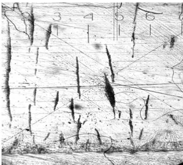
Рис. 4. Характерные микродефекты покрытия (цена деления прибора 30 мкм)
