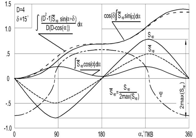
Рис. 2. Изменение основных параметров по углу поворота коленчатого вала при  $D=4$ ,  $\delta=15^\circ$ .
