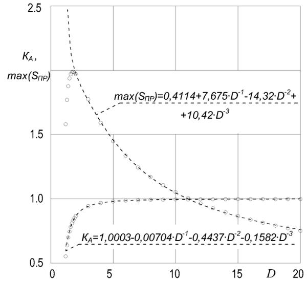
Рис. 1. Расчетные точки и аппроксимирующие зависимости для коэффициентов  $\max(S_{\text{ПР}})$  и  $K_A$ , соответственно характеризующих протечку и равновесное соотношение средних давлений в буферной полости и в рабочем контуре
