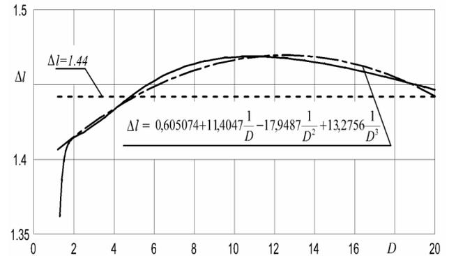
Рис. 3. Безразмерная потеря работы цикла и рекомендуемые аппроксимации
