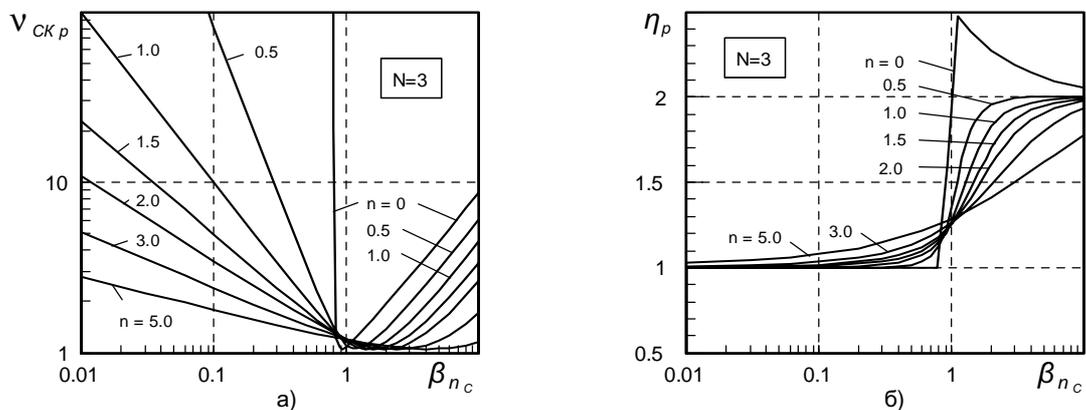
Рис.9. Резонансные характеристики по скорости при силовом возмущении: а – амплитуда; б – частота
