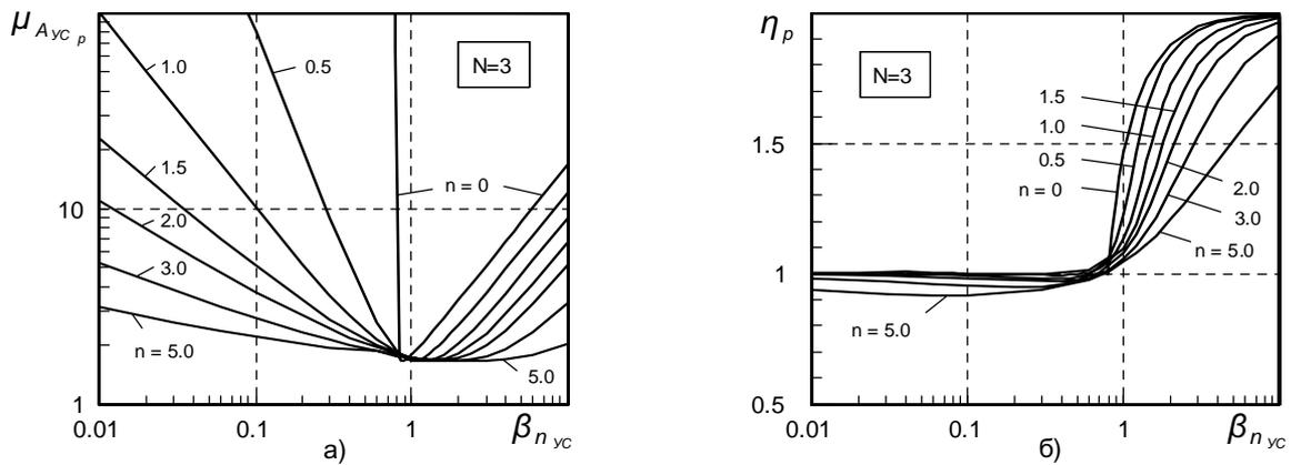
Рис.4. Резонансные характеристики по абсолютному ускорению при кинематическом возмущении: а – амплитуда; б – частота
