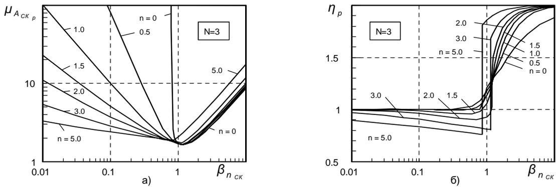
Рис.3. Резонансные характеристики по абсолютной скорости при кинематическом возмущении: а – амплитуда; б – частота
