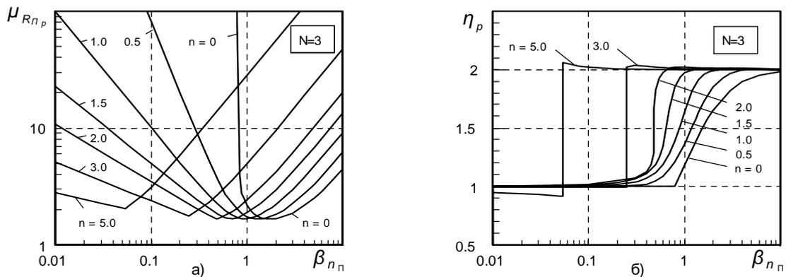
Рис.5. Резонансные характеристики по относительному перемещению при кинематическом возмущении: а – амплитуда; б – частота
