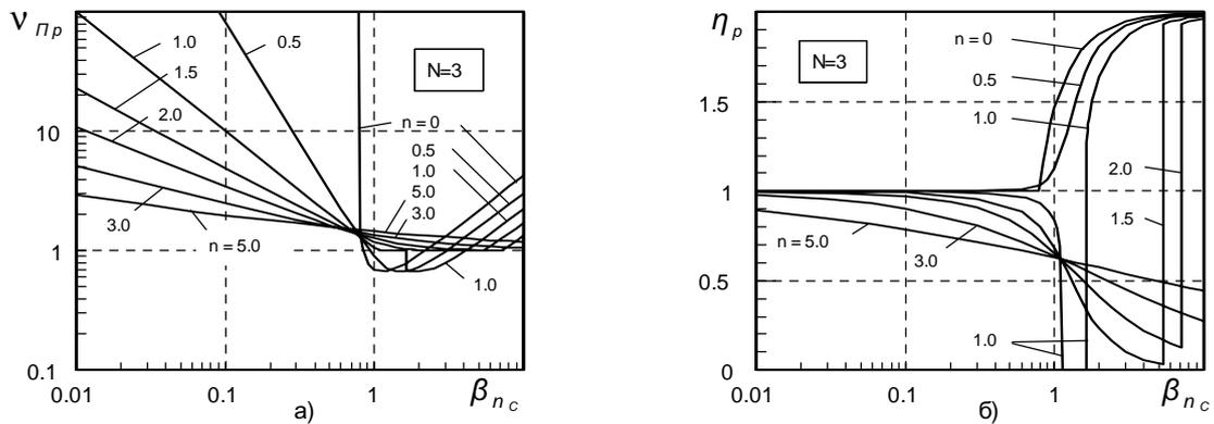
Рис.8. Резонансные характеристики по перемещению при силовом возмущении: а – амплитуда; б – частота
