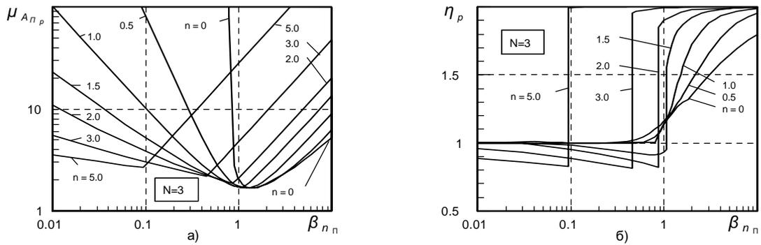
Рис.2. Резонансные характеристики по абсолютному перемещению при кинематическом возмущении: а – амплитуда; б – частота
