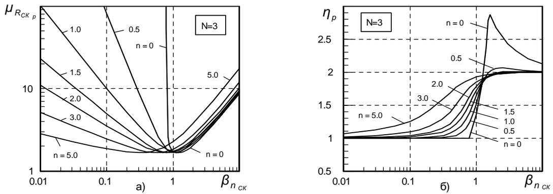
Рис.6. Резонансные характеристики по относительной скорости при кинематическом возмущении: а – амплитуда; б – частота
