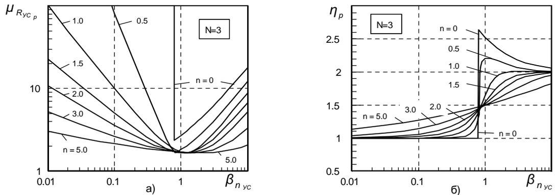
Рис.7. Резонансные характеристики по относительному ускорению при кинематическом возмущении: а – амплитуда; б – частота
