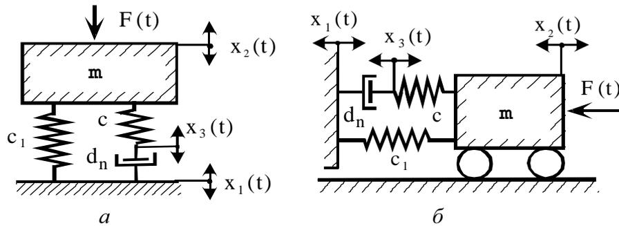
Рис.1. Схемы колебательной системы с нелинейным демпфирующим элементом, упруго установленным между виброзащищаемым объектом и основанием, при вертикальной (а) и горизонтальной (б) осцилляции объекта
