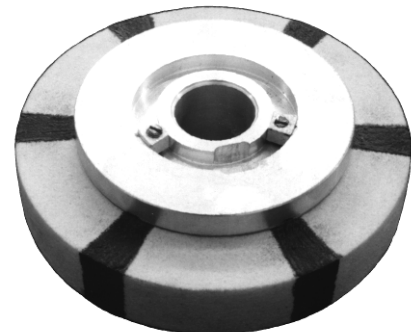
Рис. 2. Абразивные круги для круглого внутреннего шлифования: а, б – составные композиционные; в – составной комбинированный; г – сборный композиционный
