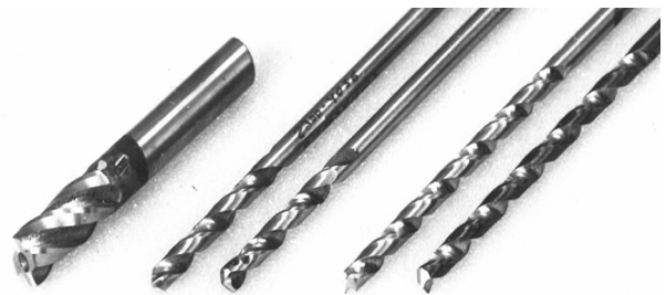
Рис.4. Фреза диаметром 8,5 мм, сверла диаметрами 4,05 и 4,15 мм
