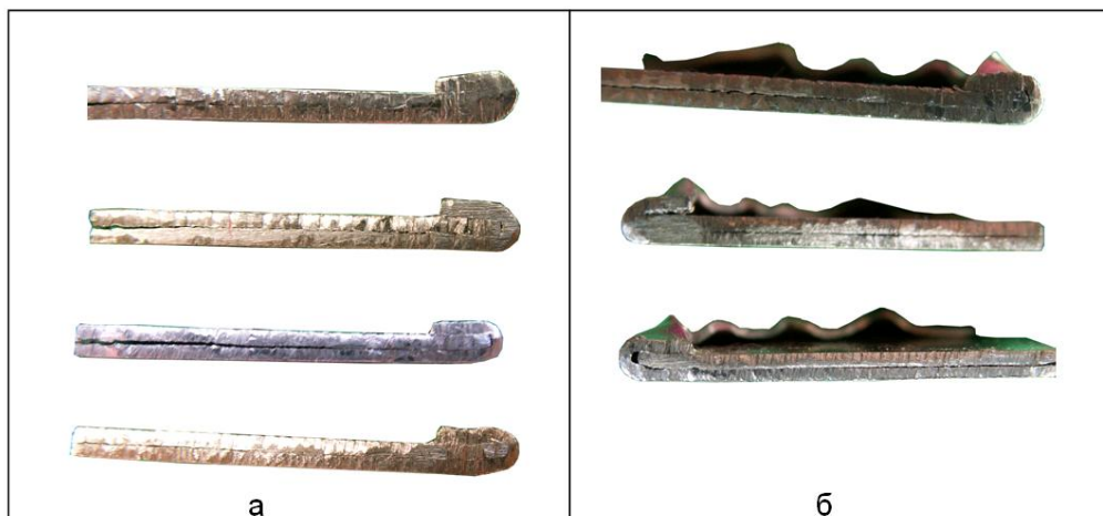
Рис. 5. Качество прилегания кромок на прямолинейных (а) и криволинейных участках (б)
