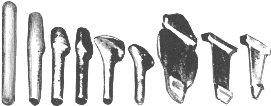
Рис.1. Технологические переходы получения заготовок объемной штамповкой
