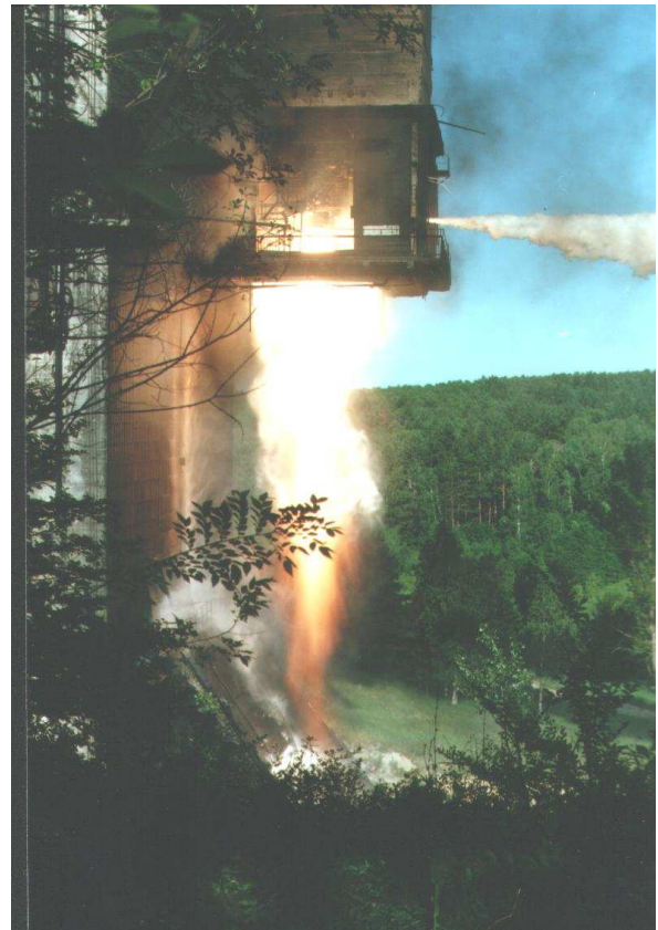
Рис. 2. Огневые испытания двигателя НК-33 на стенде ОАО «Моторостроитель», г. Самара, Россия, 1998 г.
