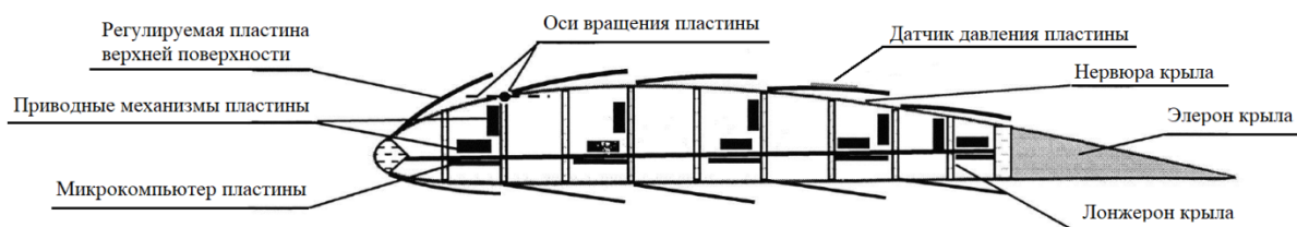
Рис. 20. Конструкция крыла с локально изменяемой кривизной профиля
