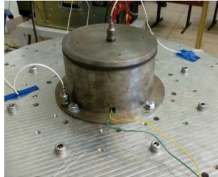
Рис. 6. Экспериментальный стенд для исследования собственной частоты демпфера
