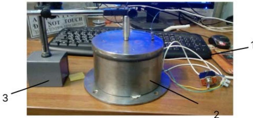
Рис. 4. Экспериментальный стенд для исследования зависимости перемещения верхней крышки от величины тока в катушке:
