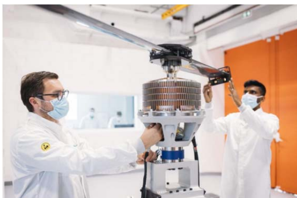
Рис. 4. Процесс проведения испытаний электрического двигателя EngineUS в исследовательском центре Safran
