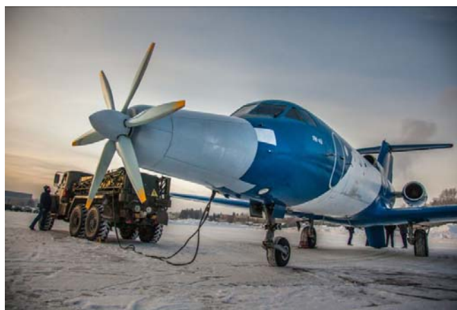
Рис. 5. Процесс испытаний гибридной силовой установки самолёта Як-40
