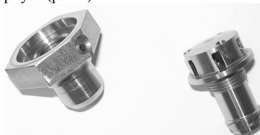
Рис. 1. Фотография изготовленных деталей новой форсунки
