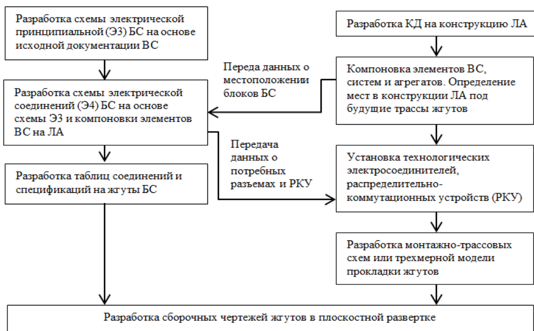
Рис. 2. Взаимосвязь этапов проектирования летательного аппарата с основными этапами проектирования компонентов бортовой кабельной сети
