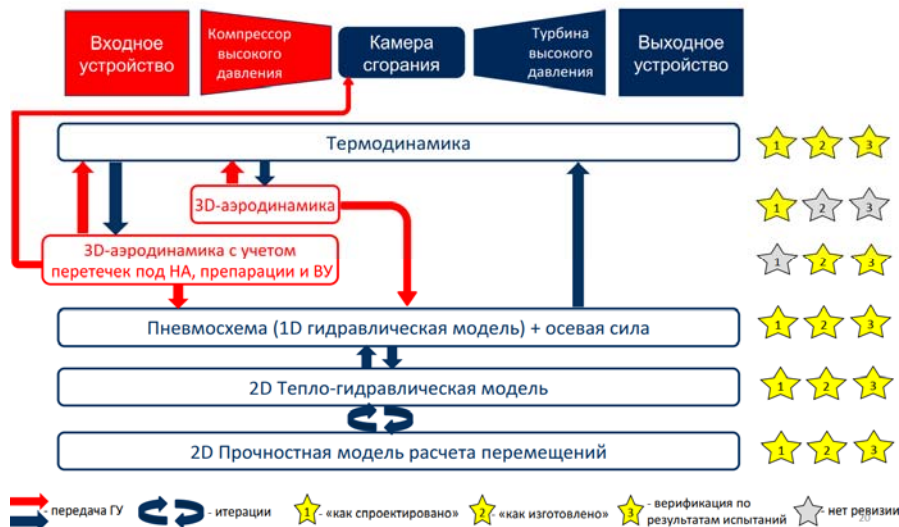
Рис. 9. Пример взаимодействия расчётных моделей в составе цифрового двойника ГТД (НА – направляющий аппарат, ВУ – выходное устройство, ГУ – граничные условия)
