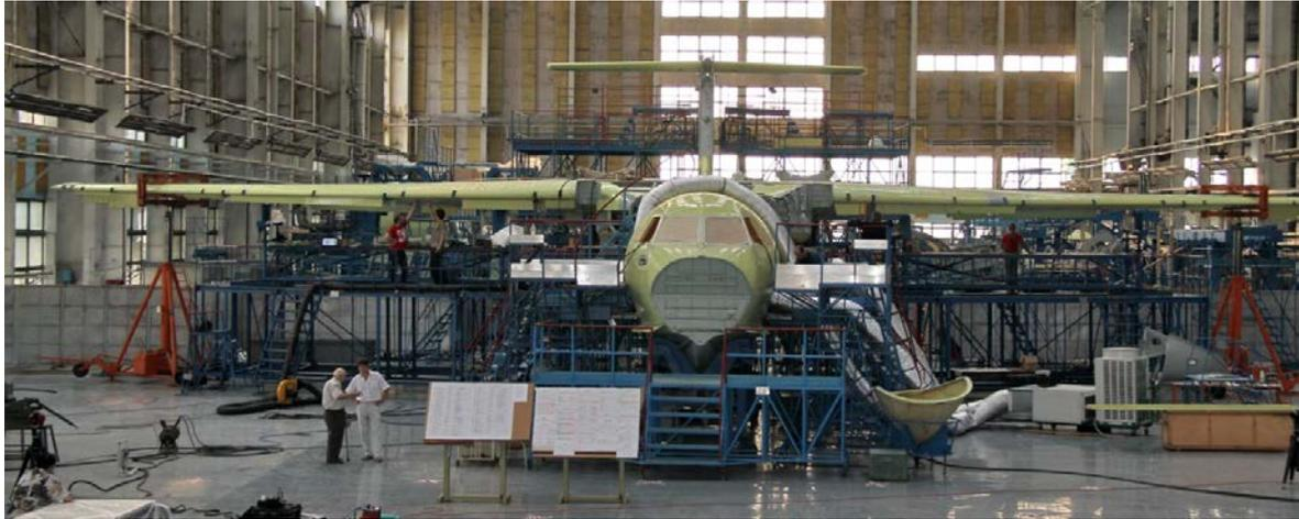
Рис. 1. Крыло серийного самолёта на этапе строительства под тестовой нагрузкой
