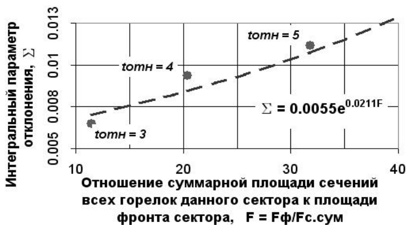
Рис. 3. Зависимость интегрального параметра качества перемешивания от относительной площади фронта
