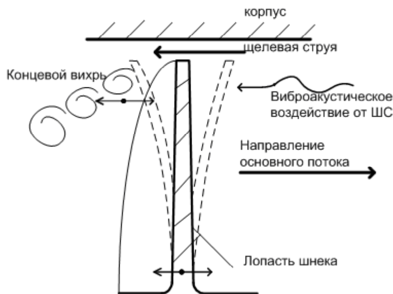
Рис. 3. Колебания лопасти шнека вследствие отрыва концевой вихря и виброакустического воздействия от ШС
