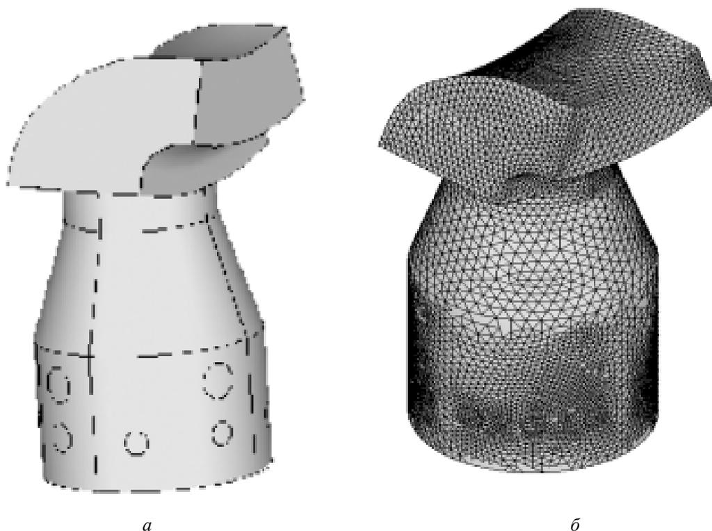
Рис. 2. Модель расчетной области: а – геометрическая, б - конечно-элементная
