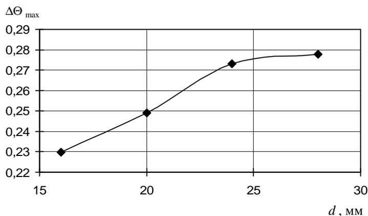
Рис. 3. Максимальная неравномерность  $DQ_{\max}$  температурного поля на выходе из камеры сгорания в зависимости от диаметра  $d$  отверстий зоны разбавления
