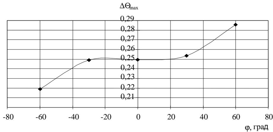
Рис. 4. Максимальная неравномерность  $DQ_{max}$  температурного поля на выходе при различных углах  $j$  вдува струй
