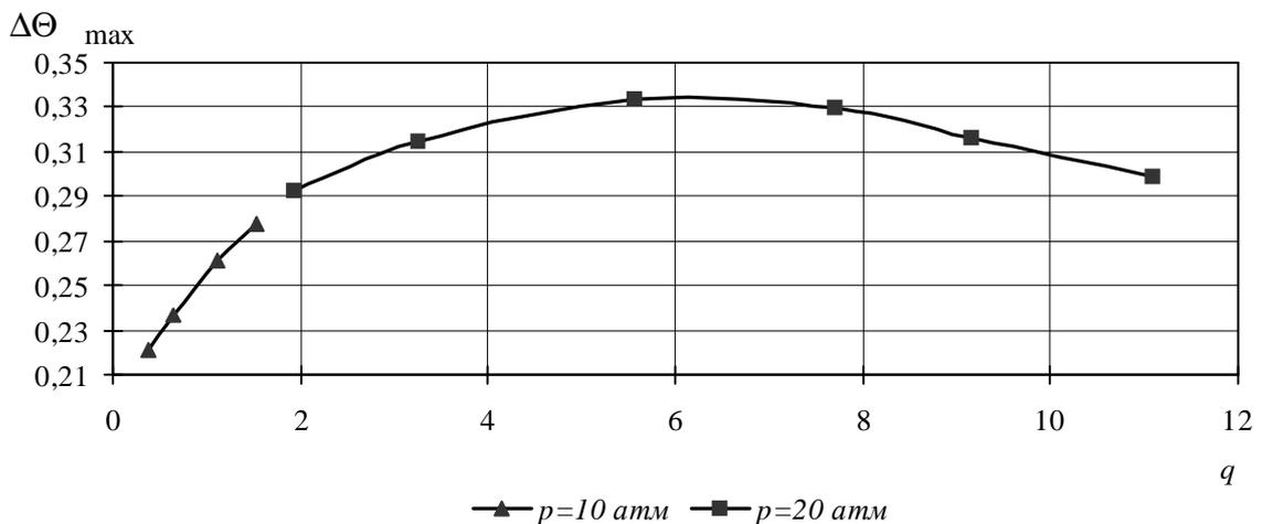
Рис. 5. Зависимость максимальной неравномерности  $DQ_{max}$  температурного поля на выходе от гидродинамического параметра  $q$
