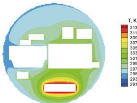
Рис. 15. Распределение температуры в сечении А-А в момент времени t = 160,0 часов
