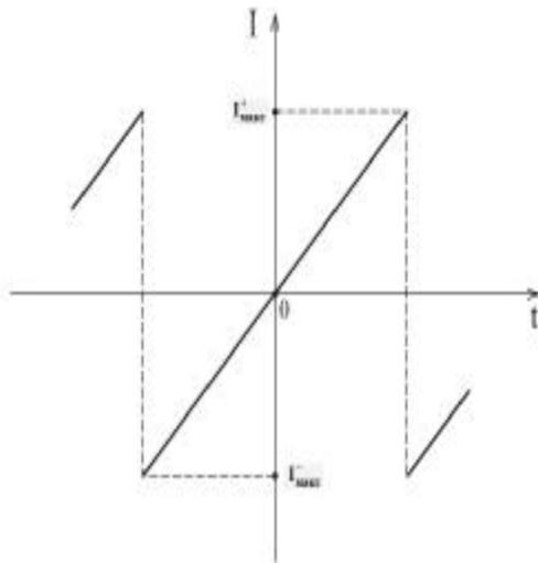
Рис. 2. Временная диаграмма работы двухполярного генератора пилообразного тока
