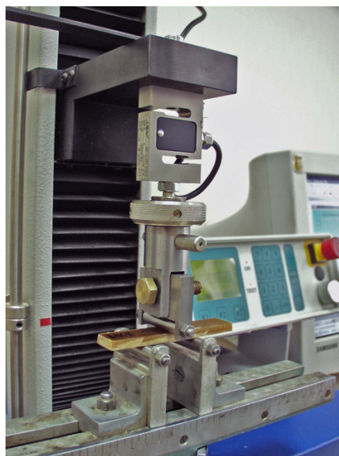
Рис. 2. Образец, установленный в приспособление для трёхточечного короткобалочного изгиба
