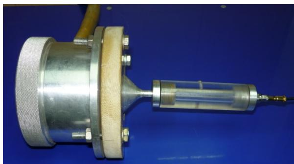
Рис. 5. Узел рабочей камеры магнитно - импульсного стенда для калибровки датчиков давления
