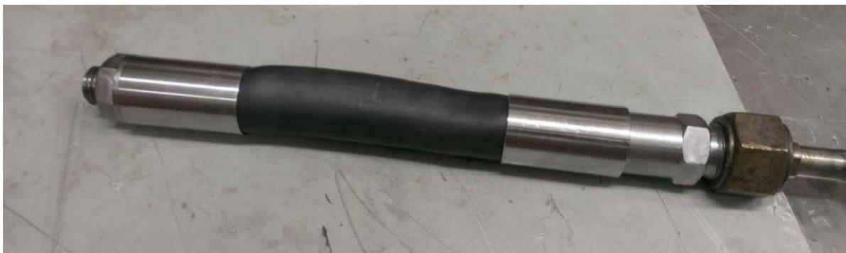
Рис. 2. Макет сборки внутренней оболочки с трубкой 20,0×3,0 ГОСТ 5496-78
