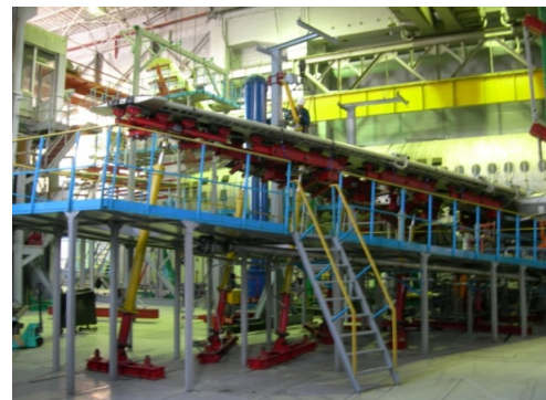
Рис. 1. Система нагружения крыла самолета SuperJet-100
