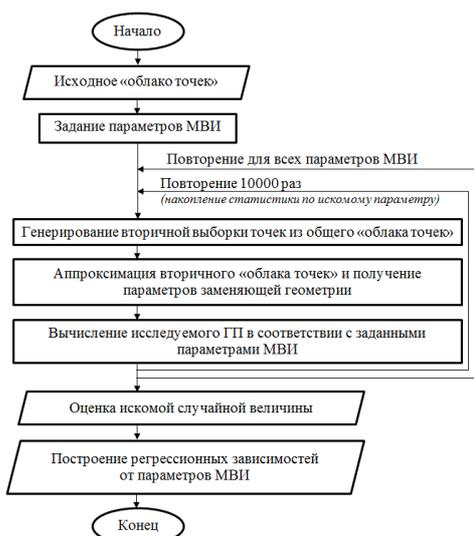
Рис. 1. Блок-схема методики моделирования процесса измерения
