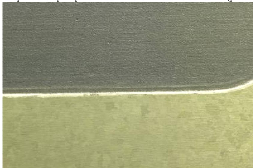
Рис. 5. Карман травленной обшивки после лазерного раскроя
