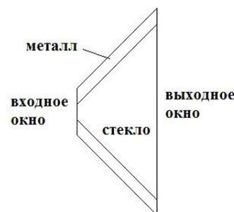
Рис. 3. Конический зонд
