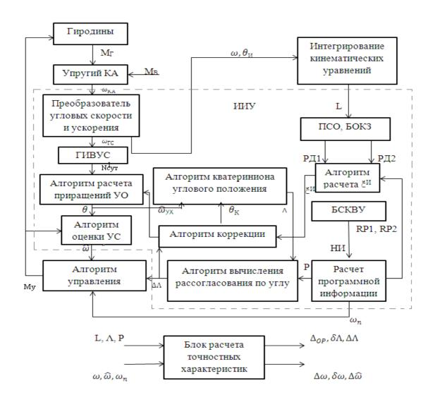
Рис. 1. Структурная схема ИИУ единого интегрированного комплекса БА
