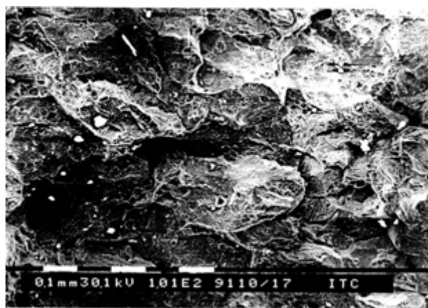
Рис.4. Разрушение крупнозернистой структуры образца №4
