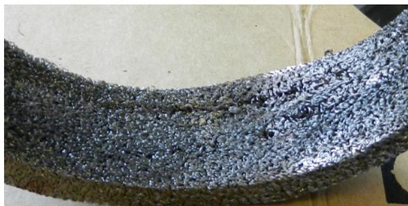
Рис. 5. Внутренняя поверхность пористого образца после 15 часов испытаний
