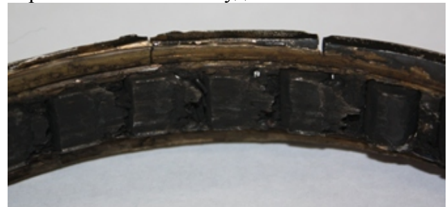
Рис. 5. Сепаратор отказавшего в полёте МРП
