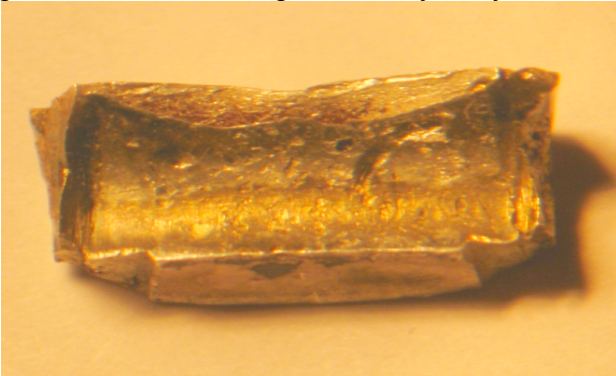
Рис. 3. Повреждённая перемычка сепаратора МРП (обратная сторона)
