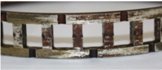
Рис. 6. Сепаратор МРП со следами неравномерного износа
