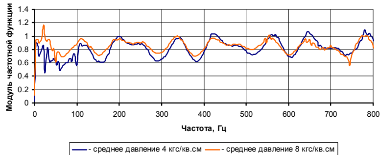
Рис. 7. Амплитудно-частотная характеристика акустического зонда №2 с параметрами: волновод D у6 длиной 0,79 м, приведённый объём полости датчика давления 100 мм 3 , корректирующий элемент в виде последовательно соединённых гибкого шланга D у6 длиной 1,8 м и металлической трубки D у6 длиной 40 м при различных средних давлениях
