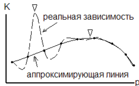
Рис. 5. Ошибка поиска глобального максимума при частоте колебаний критериальной зависимости меньшего шага дискретизации исследуемой области
