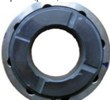
Рис. 8. Разрушение подшипника. Режим 3
