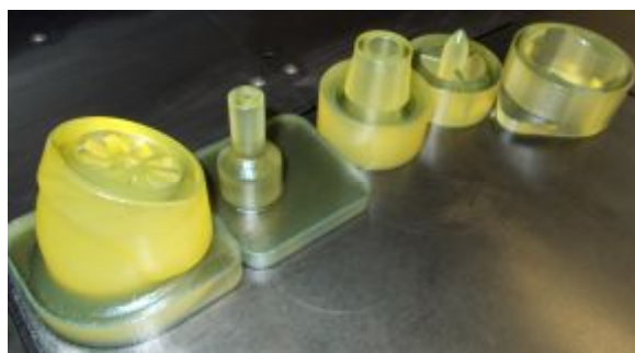
Рис. 3. Мастер-модели, полученные на 3D- принтере Objet 350
