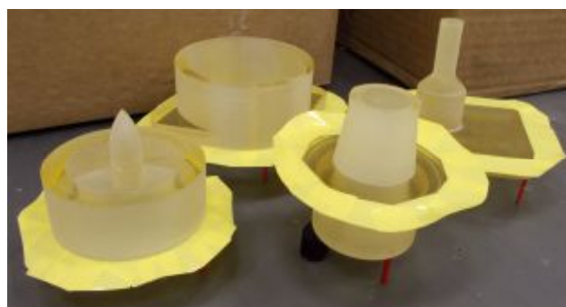
Рис. 4. Подготовленные для изготовления силиконовых форм мастер-модели изделия, выращенные на 3D-принтере
