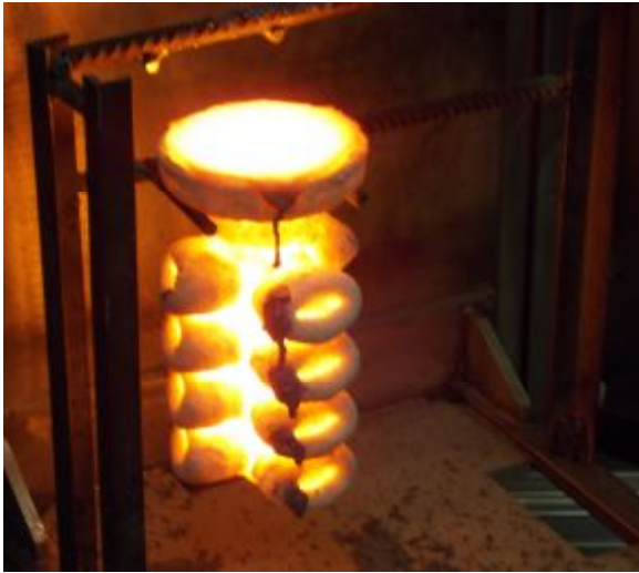
Рис. 8. Заливка керамической формы
