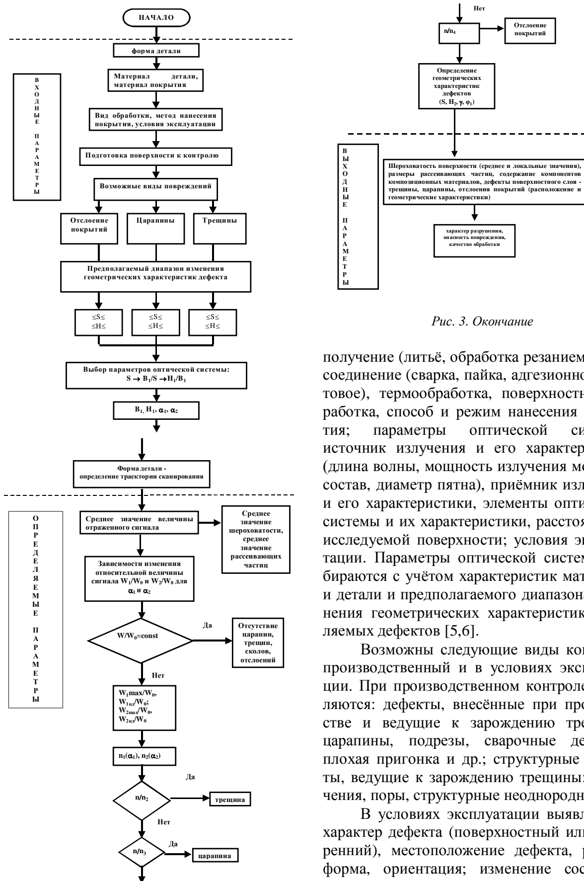
Рис. 3. Структурная схема процесса поверхностной дефектоскопии
