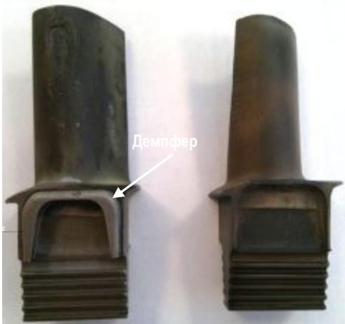
Рис. 1. Объект исследования – лопатка 1-й ступени турбины высокого давления
