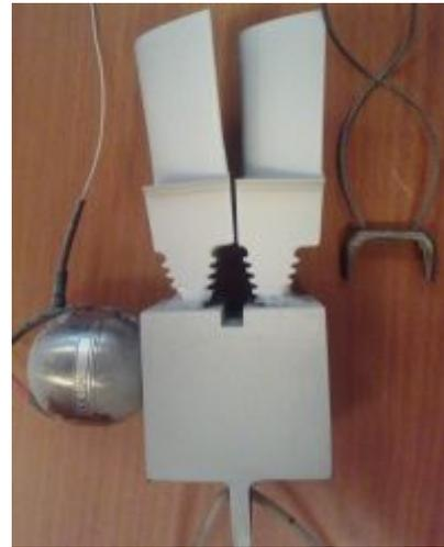
Рис.2. Блок из двух лопаток и демпфера с пьезошейкером
