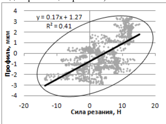
Рис. 7. Графики связи колебания диаметра обработанной детали и силы резания
