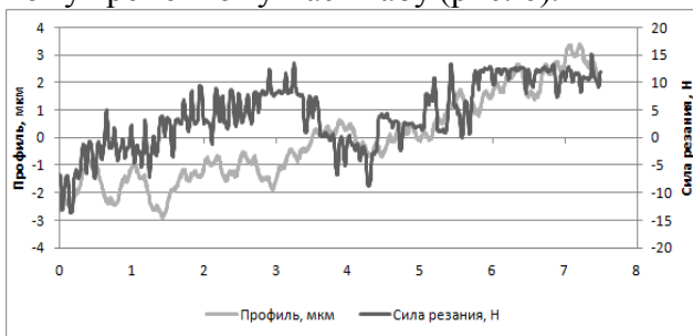
Рис. 6. Графики силы резания в процессе точения и получившегося продольного профиля поверхности образца
