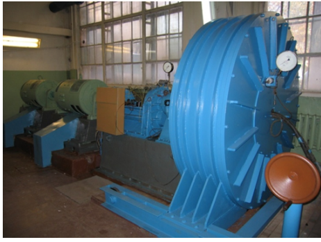
Рис. 1. Динамический разгонный стенд разработки ЦИАМ с горизонтальной осью вращения
