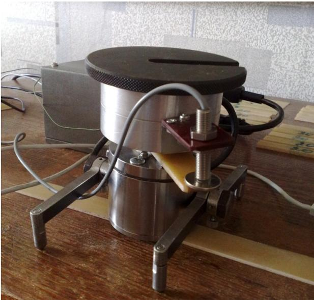
Рис. 1. Макет микропроцессорного прибора для измерения температуры стеклования
