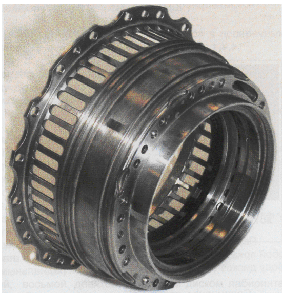
Рис. 2. Упругий элемент типа «беличьего колеса» в опоре КВД
