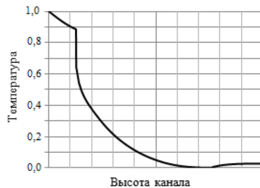
Рис. 9 Профиль безразмерной температуры по высоте сечения расчётной области
