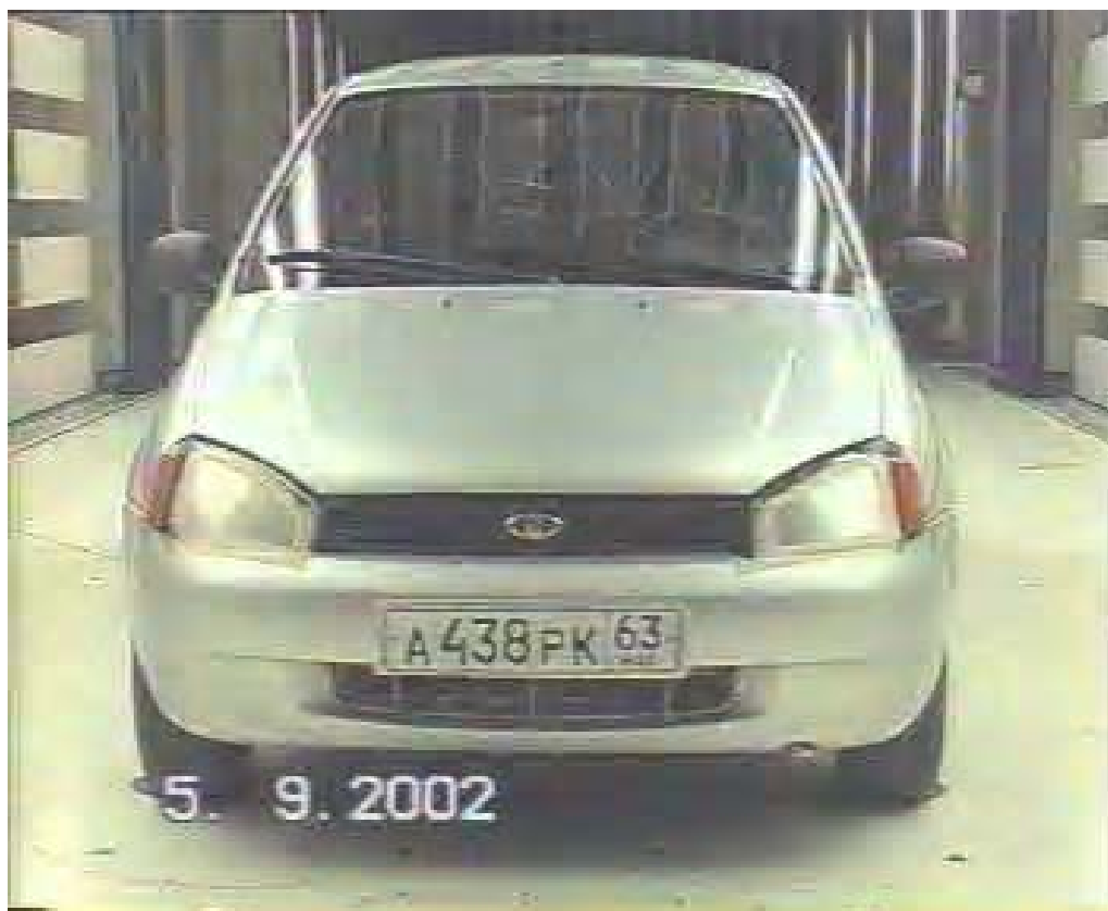
Рис. 1. Автомобиль ВАЗ-1118 по комплектации 1 с поверхностью фар-муляжей, выровненной под установку штатных стекол фар стальной лентой и пластилином
