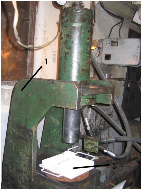
Рис. 3. Гидравлический пресс с оснасткой: 1 - гидравлический пресс; 2 - штамповая оснастка
