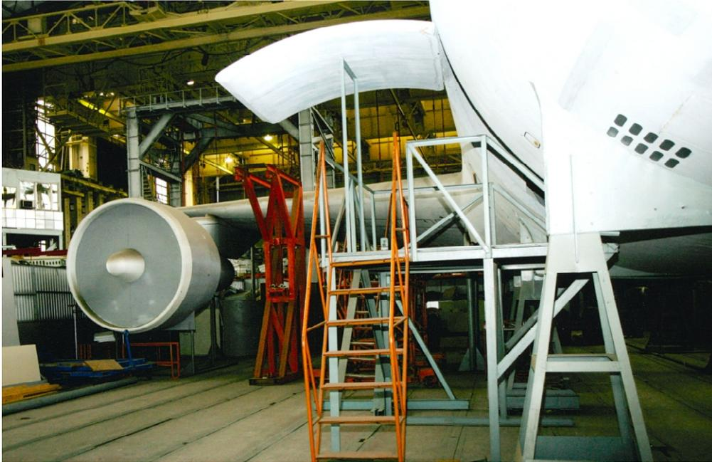
Рис. 11. Установка макета gondoly двигателя НК-93 под крылом макета самолёта Ил-96-300
