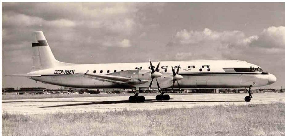
*Рис. 1. Пассажирский самолёт Ил-18 «Москва» с турбовинтовыми двигателями НК-4*
