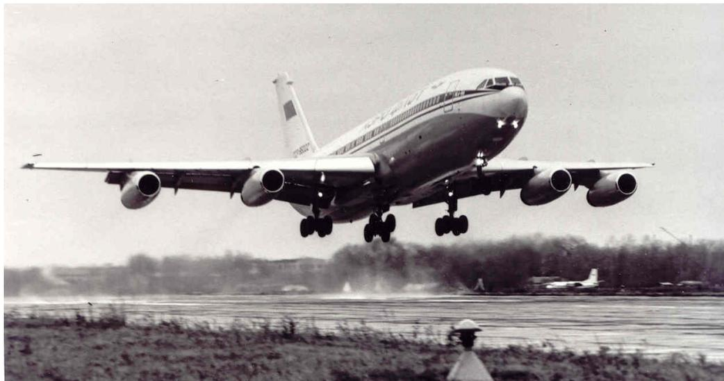
*Рис. 4. Первый отечественный широкофюзеляжный пассажирский самолёт Ил-86 на 350 мест с двигателями НК-86*
