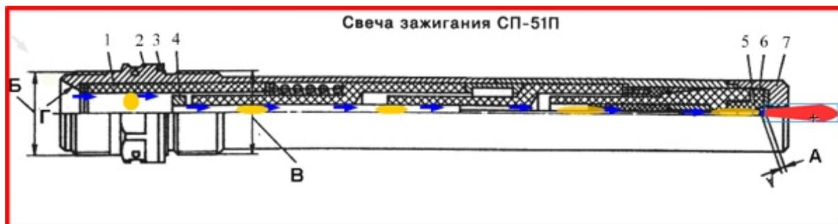
Рис. 7. Модернизированная свеча с центральным подводом воздуха и топлива
